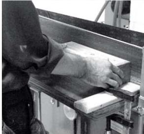
La **ponceuse à courroie** est très utile pour le ponçage des pièces de grandes longueurs.
