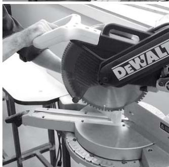
La scie à onglets est plus mobile que la scie radiale. Elle permet la coupe à angle combinés.
