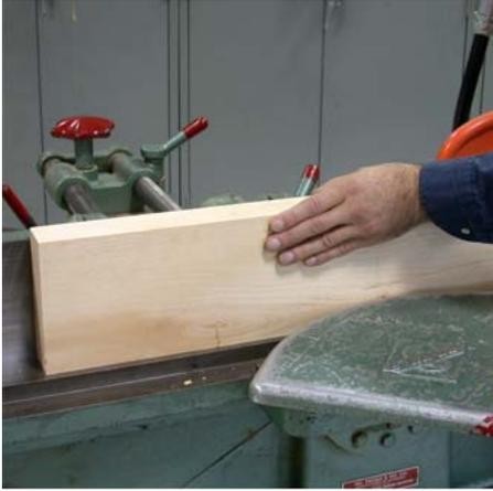
**Dégauchissage du chant d'une planche** : la différence de niveau entre les tables équivaut à l'épaisseur du bois enlevé.
