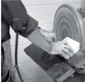
Le plateau de la ponceuse se déplace pour exécuter des **ponçages à angles**.
