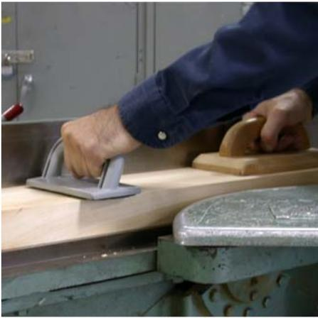
**Pour dégauchir la surface d'une planche**, toujours utilisez les poussoirs pour plus de sécurité.
