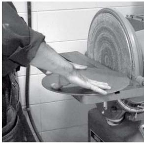
**Ponçage sur disque** : Présentez l'ouvrage en pressant fermement la pièce de bois sur la table afin d'éviter que la pièce ne soit emportée par la ponceuse.
