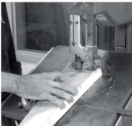
Avec la scie à ruban de l'atelier, on coupe du bois jusqu'à 15,2 cm d'épaisseur.
