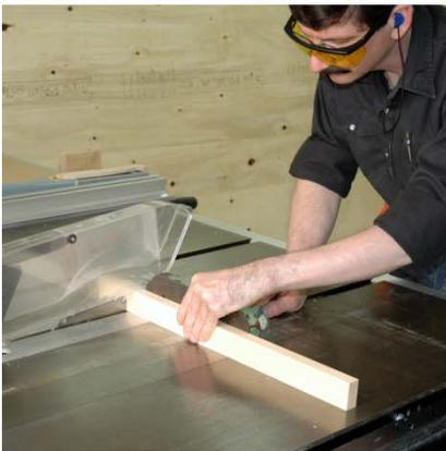
**Tronçonnage** : Réglez le guide d'onglets à l'angle désiré (ici, 90 °). Pressez l'ouvrage sur l'épaulement et faites une passe lente.
