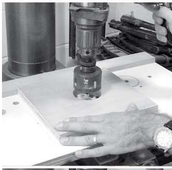
**La scie emporte-pièce** découpe dans le bois et le métal des trous de 19 mm à 6,3 cm. Profondeur de coupe : 19 mm.
