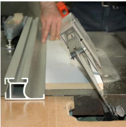
**La coupe en biseau** se fait en inclinant la lame à l'angle désiré. Une gradation est indiquée sur le mécanisme d'inclination.
