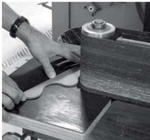
On **ponce les courbes concaves** sur la partie courbe de la courroie. Tenez la pièce en mouvement en vous appuyant toujours sur la table.
