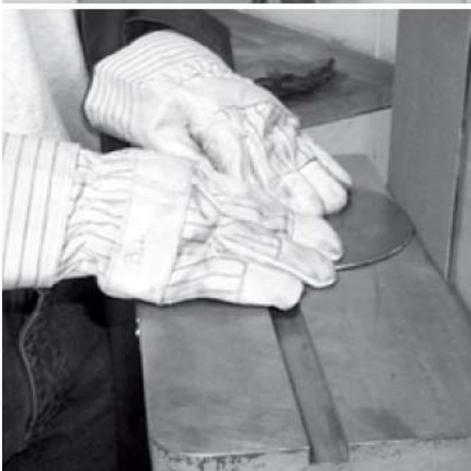
Éloigner les mains de la surface abrasive et ne pas exercer de pression excessive sur la pièce en cours d'exécution. Toujours vérifier le sens de la rotation du disque avant d'effectuer le travail; appuyer la pièce dans la partie gauche du disque.
