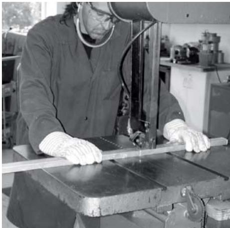
Placer les mains parallèlement de chaque côté de la lame en tenant bien la pièce et en exerçant une poussée raisonnable et constante.
