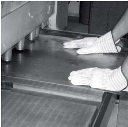
Placer les mains loin de la tranche et des pistons hydrauliques.
